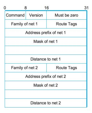
Figure 3.32.: RIPv2 packet format.
