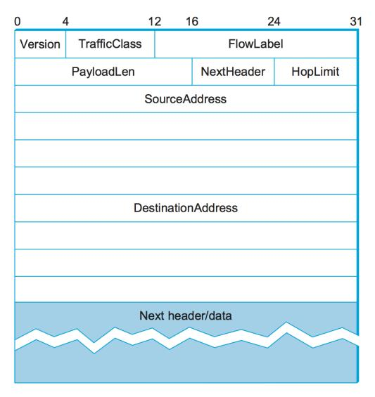
Figure 4.12.: IPv6 packet header.
