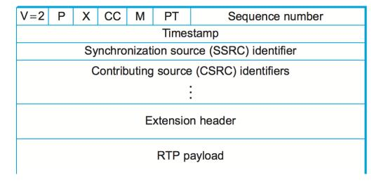
Figure 5.25.: RTP header format.
