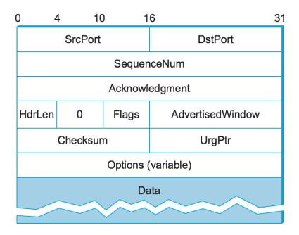
Figure 5.4.: TCP header format.
