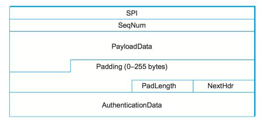
Figure 8.17.: IPSec's ESP format.
